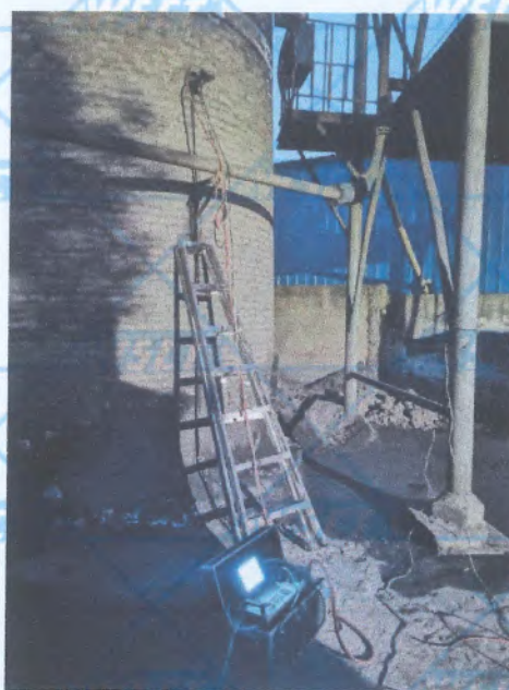
锅炉废气采样
